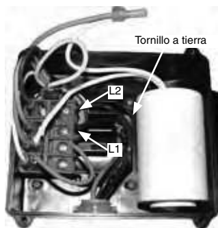
Cableado de 230 VCA (de fábrica)
